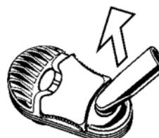
► Démonter l'Embout du couvercle de l'Unité de Refroidissement en le tournant légèrement dans les deux sens.
