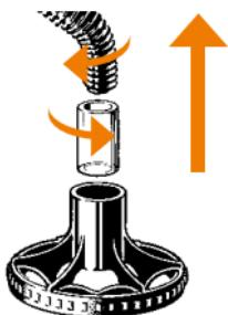
Kühlspirale aus dem Füllkammerdeckel herausziehen
