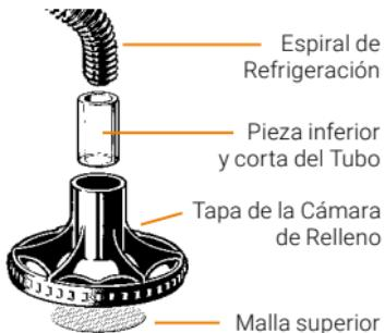
Saque la Espiral de Refrigeración con un movimiento giratorio leve de la Tapa de la Cámara de Relleno y a continuación, retire la Pieza del Tubo de la Espiral de Refrigeración.
