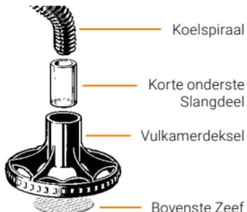
Neem de Koelspiraal met een lichte draaibeweging uit de Vulkamerdeksel en trek daarna het Slangdeel van de Koelspiraal.
