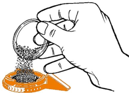
Toujours remplir jusqu'au bord supérieur de la Chambre de Remplissage
