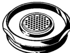
La Capsula dosatrice inserita nel Riduttore della Camera di Riempimento
