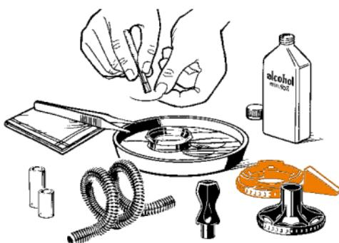
Nettoyage manuel à l'alcool (min. 90 %) ou au produit à vaisselle. La Spirale de Refroidissement peut aussi être rachetée.
