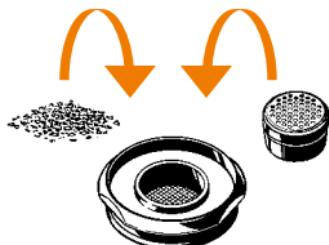
Llenar el Reductor de Cámara de Relleno directamente con material vegetal triturado o con una Cápsula Monodosis llenada
