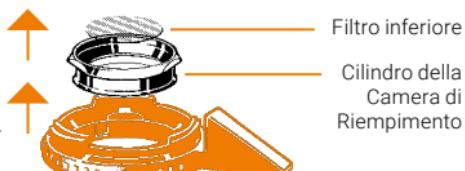
Alloggiamento della Camera di Riempimento
