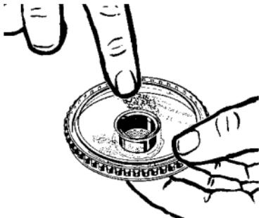
Dosierkapsel beim Befüllen mit Magazindeckel (Trichter)
