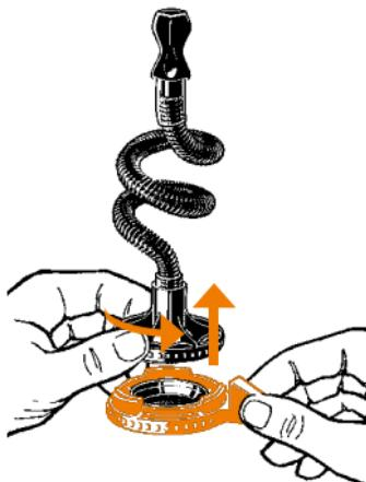
Retirer le Couvercle de la Chambre de Remplissage avec la Spirale de Refroidissement
