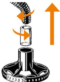
*Sacar la Espiral de Refrigeración de la Tapa de la Cámara de Relleno*
