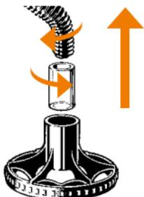
Retirer la Spirale de Refroidissement du Couvercle de la Chambre de Remplissage
