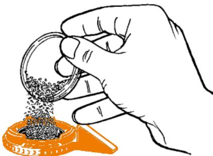
Füllkammer immer vollständig bis zum oberen Rand befüllen
