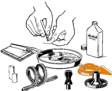
Handmatige reiniging met alcohol (min. 90 %) of afwasmiddel. De Koelspiraal kan ook nageleverd worden.
